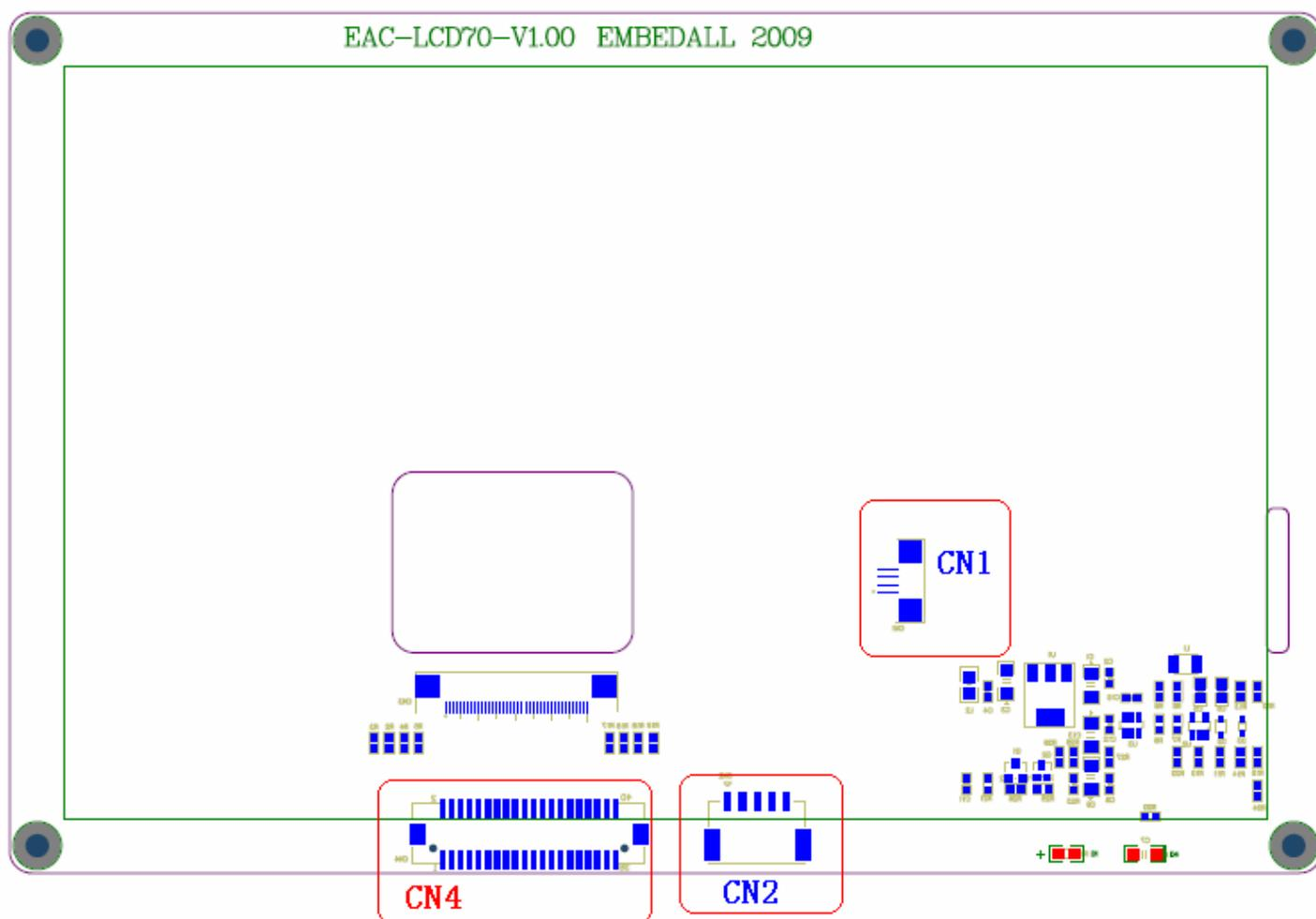
CN4 为 18 位 TFT LCD 信号输入接口，CN2 为四线带阻的触摸屏数据输入端，CN1 为直接和四线带阻的触摸屏数据线相连。详情请看接口定义说明。
